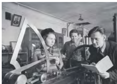
Фото: «Студенты второго курса металлургического института имени Сталина за испытанием на разрыв металлического стержня. Днепропетровск» (1944)
